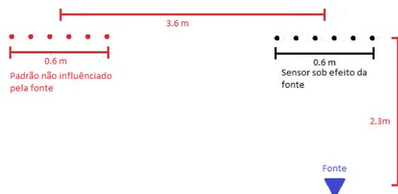
Figura 3: Análise dos Sensores sob Efeito da Fonte de Deslocamento de Ar
